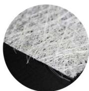
Chopped strand mat, legante emulsione, grammatura 450g/m<sup>2</sup> indicato per hand-lay-up con resine poliesteri insature. Una struttura GRP standard contiene 2,5 kg di resina ogni kg di mat.
